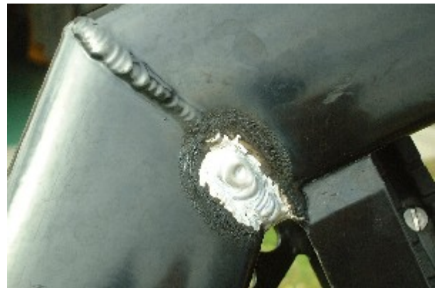
補修されたアルミ製ウイングリガー(写真:取材協力:四万十RC)。
