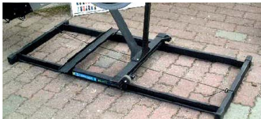
スライド。漕手の体重移動の負荷を乗艇に近づけることができる。
