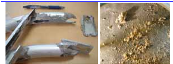
腐食したアルミ製リガー・フレームと、ハル内に散らばる腐食生成物
