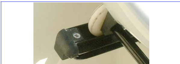
シングル・アクションでは、バック(またはフロント)・ストップを外す。
