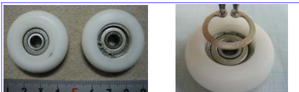
ホイールとそのベアリング、スナップリングプライヤーによる着脱。
