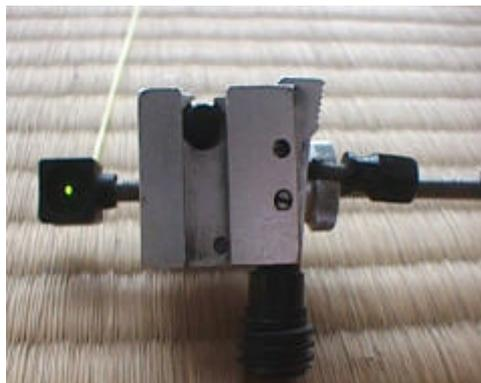
せっかく作ったサイトピンを使うために本当に使えないのか考えてみた。実際に狙いをつけてエイミングしている時は的に目のピントを合わせてサイトピンはぼやけて見えている。そして的とサイトピンは効き目で合わせているが反対側の目も使った的を見ると効き目でないほうで見えるサイトピンも見えて2つ見えているはずである。そのとき両目は同じ的にピントを合わせているわけで、これを利用して改良した方法が以下の方法である。
