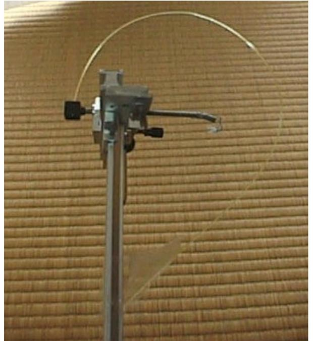
ここの問題は後の試作で先端のねじ部を加工して小さな穴をあけたピンを作ってまわりはアルミ板を加工したリング穴を取り付けるものは作った。写真は見えるタイプであるが、現在は元のままの見えにくいままで使っている。
